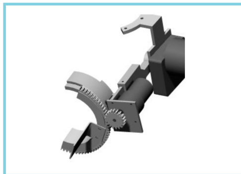
(c). Detalle mecanismo de prona y supina de la muñeca
